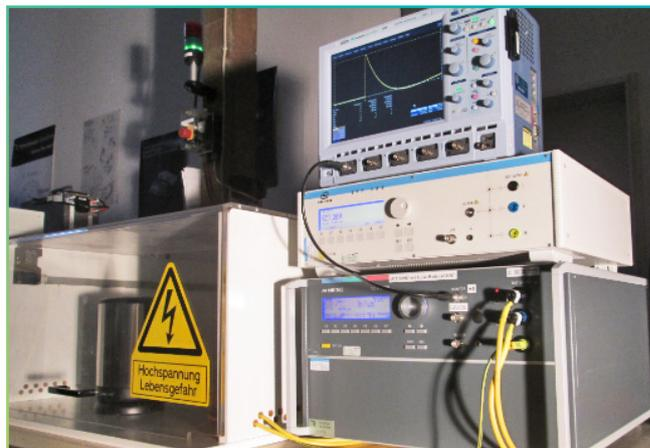
Prüfplatz: Störfestigkeit gegen schnelle transiente elektrische Störgrößen/Burst und gegen energiereiche Impulse/Stoßspannungen.
