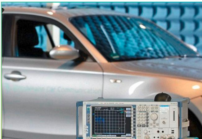
Eigenentstörung eines Fahrzeuges in der Absorberhalle.
